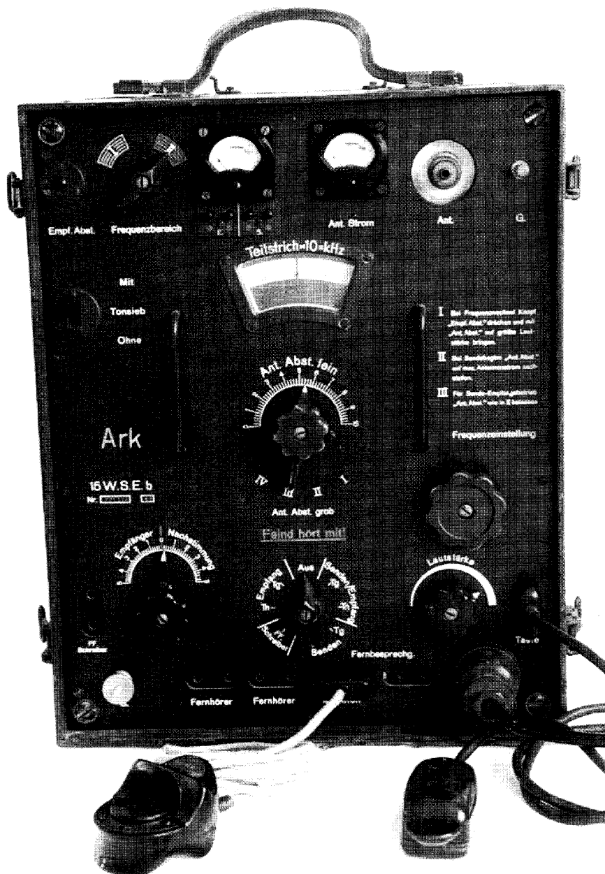
Fig. 1. 15 Watt Sender-Empfänger b van voren gezien. Het beschermdeksel is verwijderd. (Foto: PA0SE).
